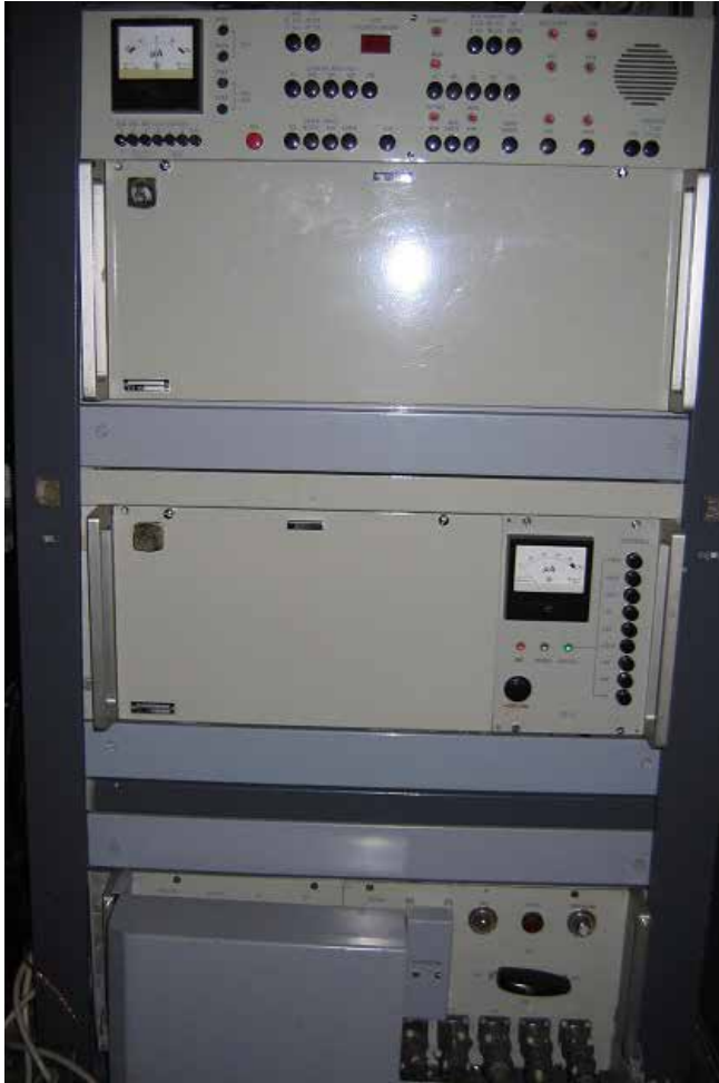
Urządzenie UTD-3CT (bez bloku utajniającego)
