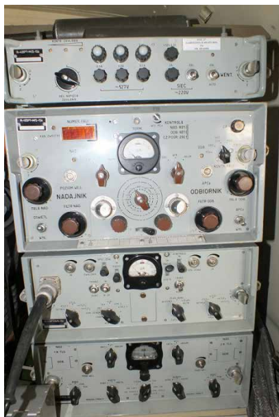
Półkomplet radiolinii R-405PT-M/S-1Sz wewnątrz radiostacji R-140M
