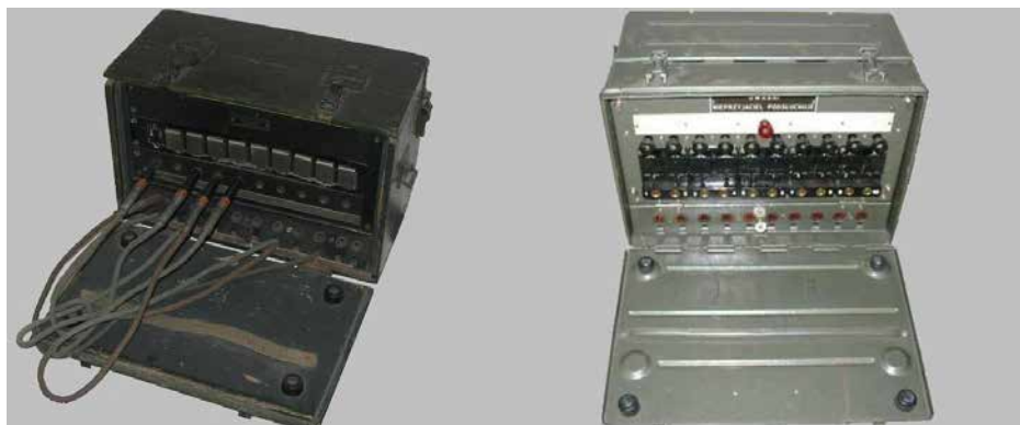
Łącznica w obudowie drewnianej(z lewej) i metalowej(z prawej)
