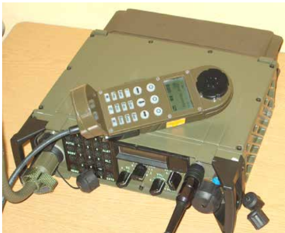
Radiostacja TRC 9200 (z mikrotelefonem wielofunkcyjnym MTW)
