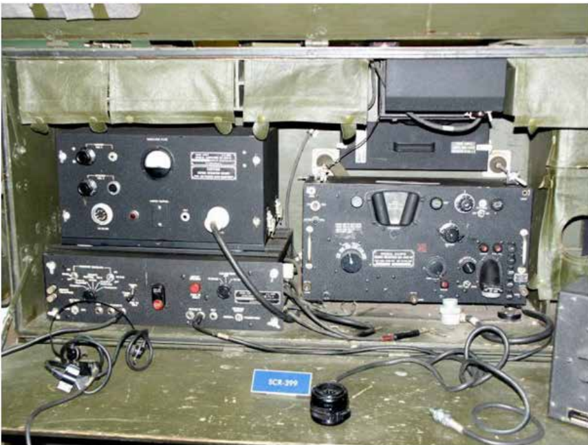
Wnętrze radiostacji SCR-399
