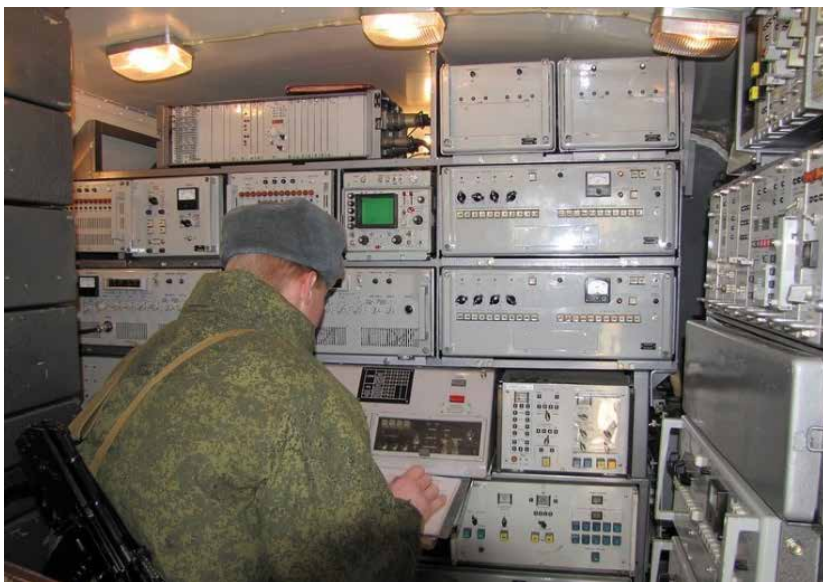
Wnętrze stacji łączności satelitarnej R-440
