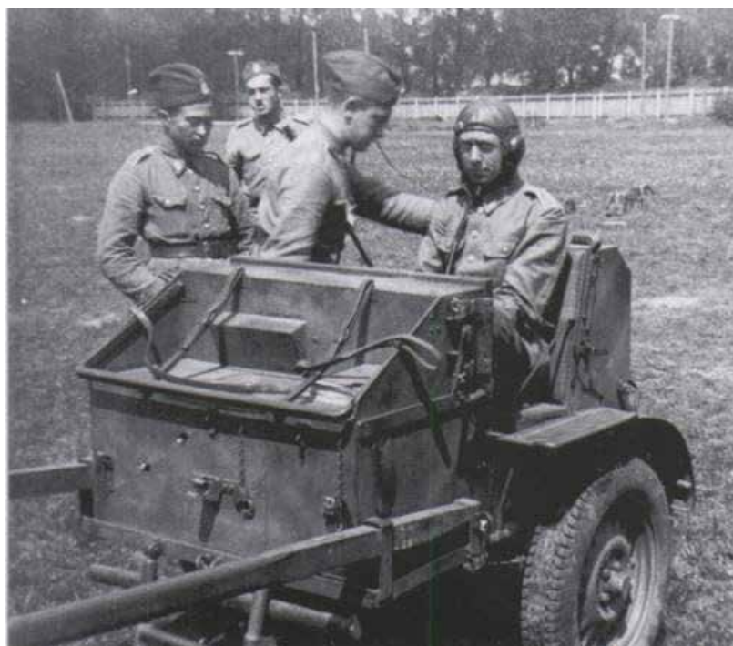
Radiostacja N2 na jednoosiowej biedce
