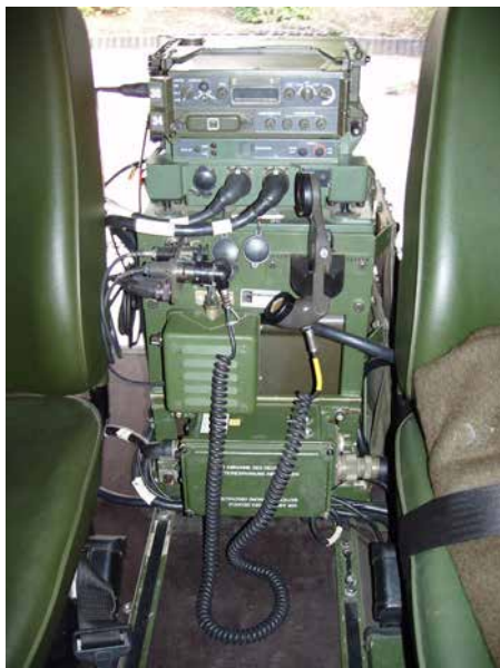
Wnętrze wozu dowodzenia WOLF – wersja z radiostacją SEM 90
