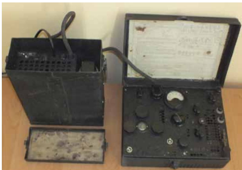
Radiostacja BP5 z zasilaczem
