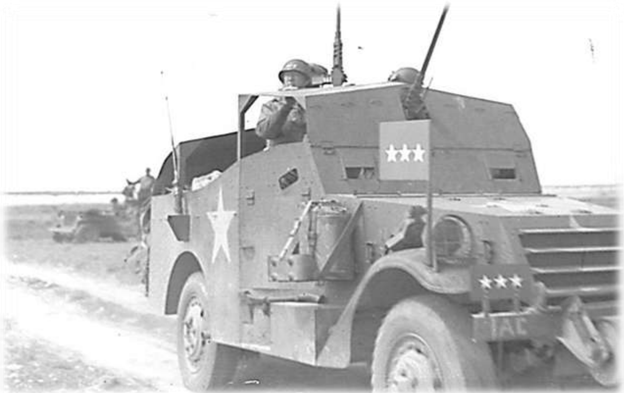
Kołowy transporter opancerzony M3 Scout Car, zwany też White Scout Car (transporterów tych często używali łącznościowcy, gdyż wyposażone były w radiostacje).
