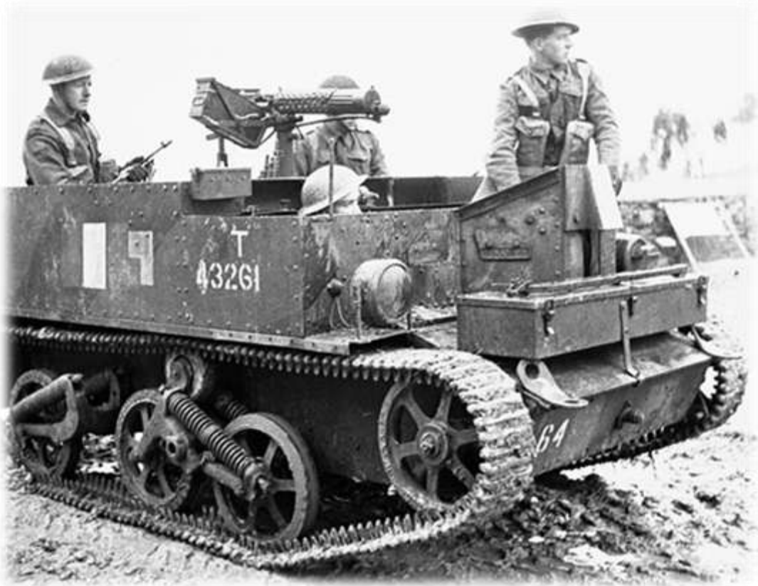
Gąsienicowy lekki transporter opancerzony Universal Carrier, wyposażony w ckm Vickers 7,7mm. Źródło: By Lieut. Alexander M. Stirton, Library and Archives Canada under the reproduction reference number PA-189892, https://pl.wikipedia.org/wiki/Universal_Carrier#/media/File:Universal_Carrier_A189892-v6.jpg , domena publiczna (dostęp 19.12.2016).
