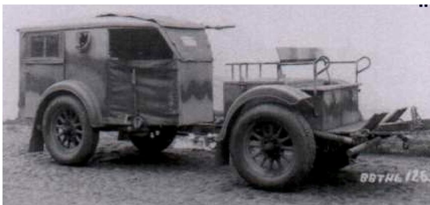
Radiostacja w wersji taczankowej (wóz wz. 39)
