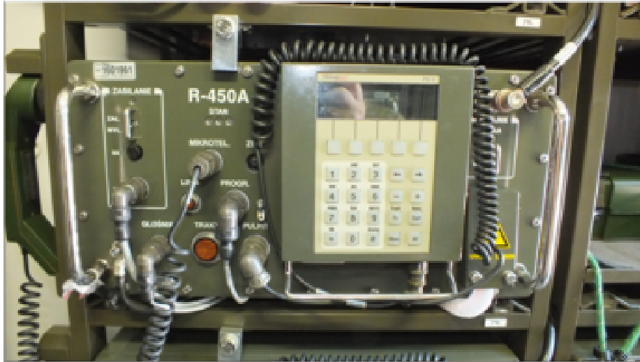
Radiolinia R-450A zamontowana w aparatuwni RWŁC-10/T
