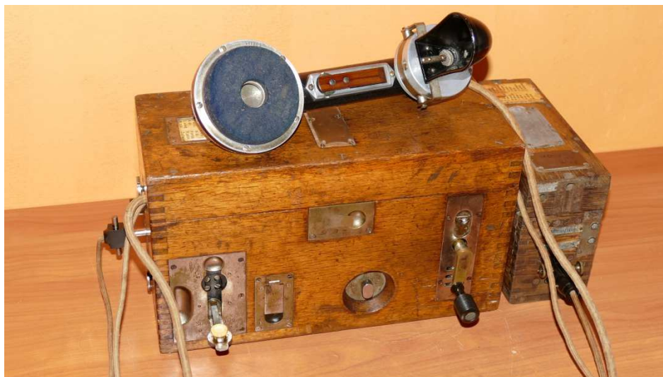
Niemiecki aparat induktorowo-brzęczykowy typu „starego”
