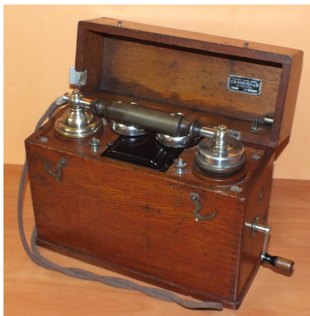
Induktorowy telefon polowy wz. 1915 firmy Ericsson
