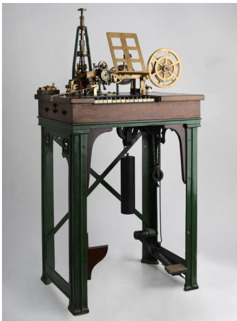
Telegraf Hughesa (z lewej francuski, z prawej niemiecki firmy Siemens & Halske)
