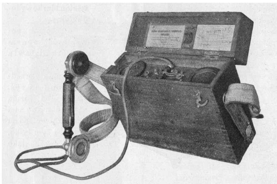
Rosyjski aparat brzęczykowy firmy Ericsson
