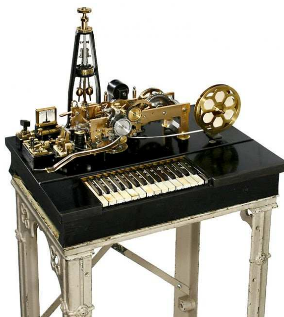
Telegraf Hughesa (z lewej francuski, z prawej niemiecki firmy Siemens & Halske)
