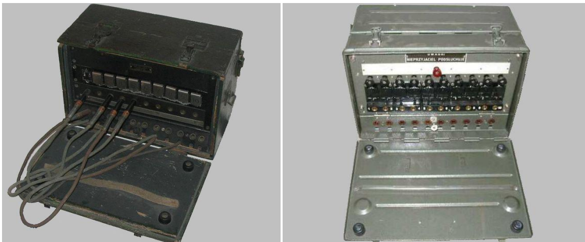
Łącznica w obudowie drewnianej (z lewej) i metalowej (z prawej)
